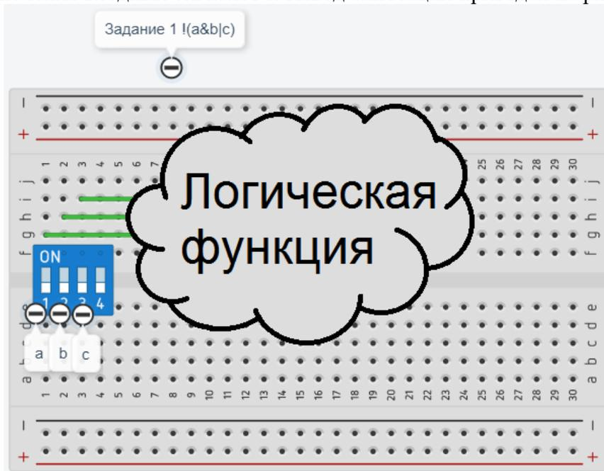
Рис. 2. Пример подключения входных сигналов и вывод аннотации
